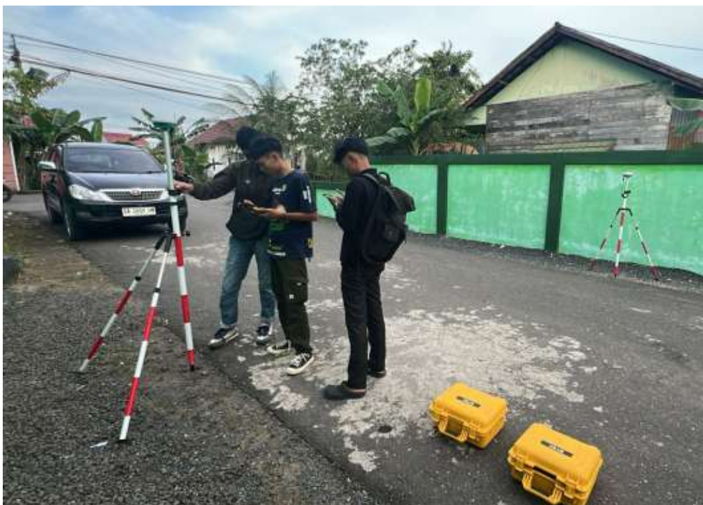
Gambar 5. Survey Topografi dengan GPS Geodetic di Desa Martadah Baru (Juli 2025)
