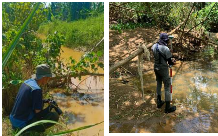
Gambar 7. Survey Bathimetri dengan Hand Sounder di Sungai Martadah (Juli-Sept 2025)
