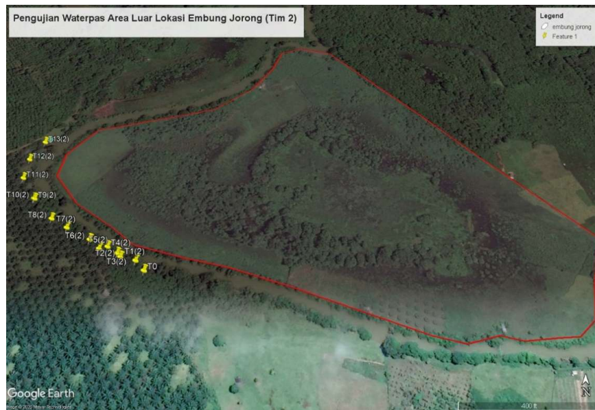
Gambar 4. 2 Titik Pengukuran Elevasi Lahan dengan Waterpass Area Luar Embung Tim 2
